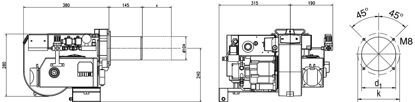
X= Расширение трубки горелки 100 mm и 200 mm
