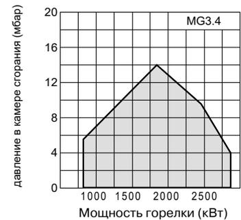
Рабочие поля соответствуют норме DIN EN 676. Поля действительны для атмосферного давления 1013 мбар и температуры 15°C.
